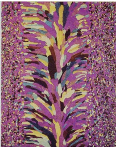
Fig. 10a. Tvärsnitt genom en svetsfog, där smälta vid stelning har utvecklat (krökta) dendritar. Termisk etsning som visar olika kristallorientering hos de olika dendriterna.
