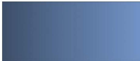
Fig 12c. Diffusion av B-atomer in i områden åt höger med låg koncentration av B-atomer. Normalt sker koncentrationsutjämnning.
