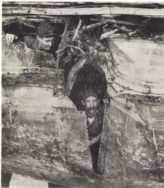
MINKABELBÅTEN N:O 2 EFTER KOLLISIONEN MED ÅNG. "BELE" PÅ RIFÖFJORD. Minkabelbåten under upptagning. Öfverst en bild af den svåra läcka den erhöles vid kollisionen.
