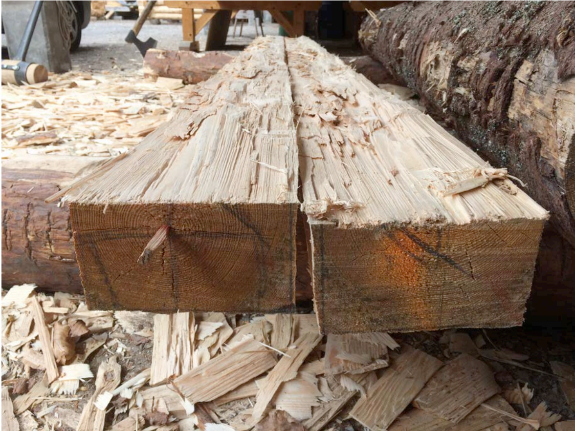
Fig. 26 Blocket klyvt. Observera den förskjutna mårgen
