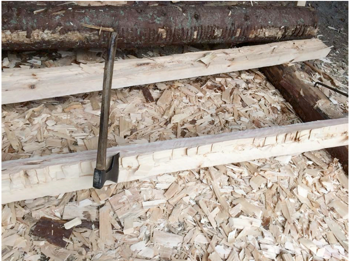
Fig. 28 Sprätthuggning av klyvt ämne för att åter få ett block att arbeta med.
