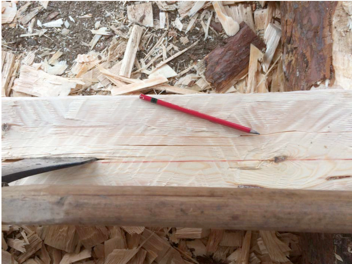
Fig. 24 Spårning, Detalj: Uppkomst av parallella sprickor jämte klyvspåret (pennan pekar mot sprickan).
