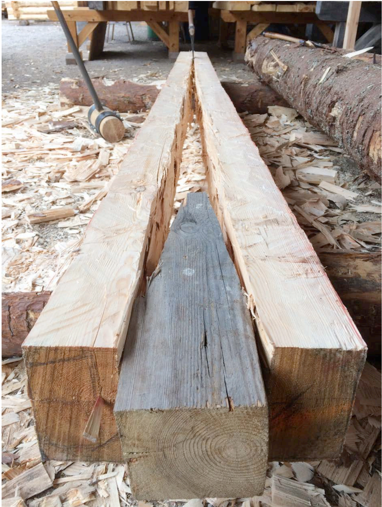
Fig. 25 Klyvmomentet, notera spänsten i virket. Kilen isatt för att sära på klyvet, den utövar inte något större tryck i spåret.
