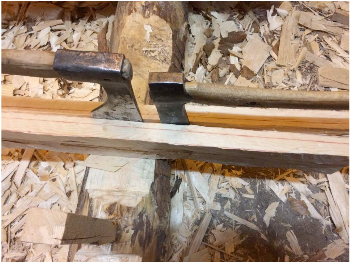
Fig. 32 Spårning: Tvärgående fibrer skärs av med knutyxa.
