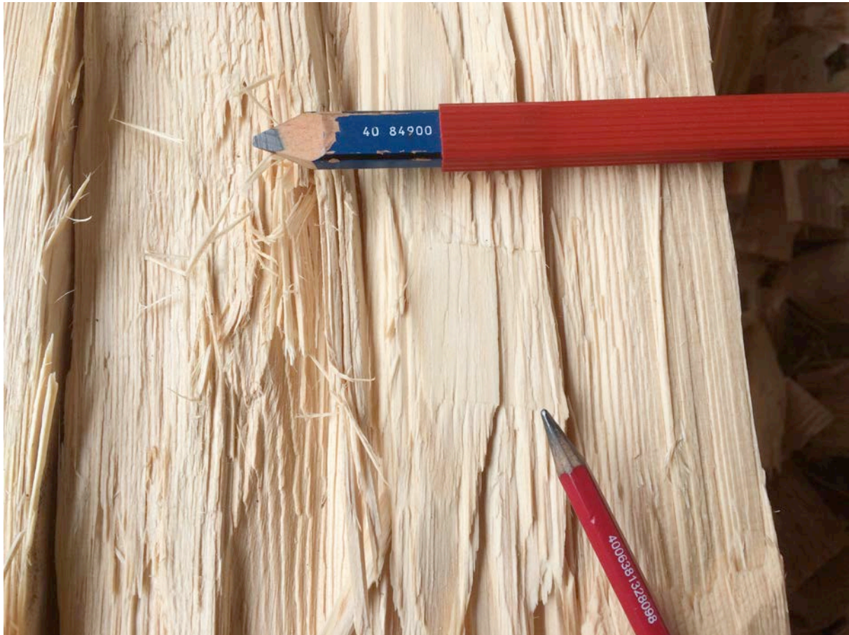
Fig. 36 Spårning: Spår efter spårning, jämför mot Fig. 2. Den grova pennan visar nedslagsriktningen för yxan, den mindre pennan pekar på spåren efter den skärande eggen vid nedslag.
