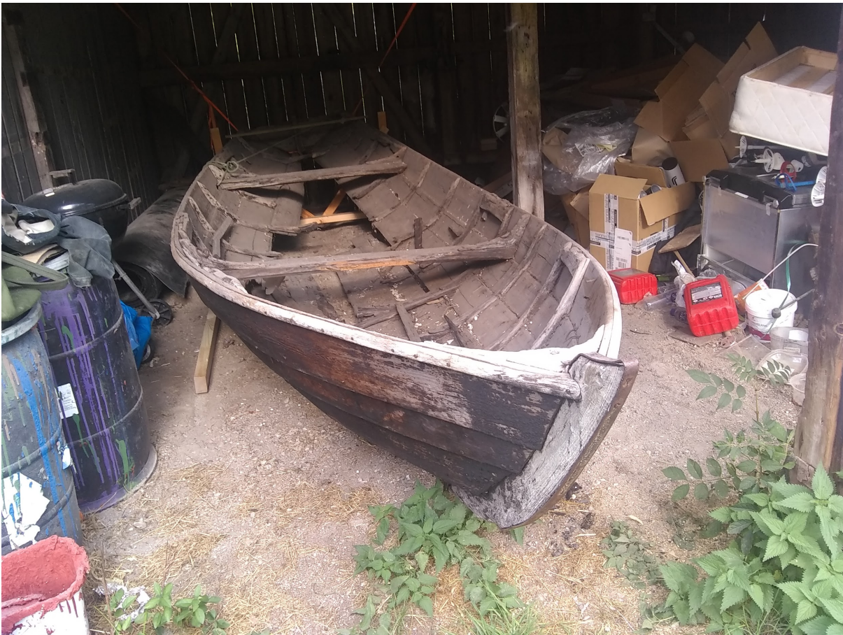
Figur 9. Inledning av rekonstruktionen, akterskeppet har lyfts i stroppar och monterats i en vagga för att avlasta botten. På bilden är skrovet vridet skevt och dess trasiga botten är synlig.
