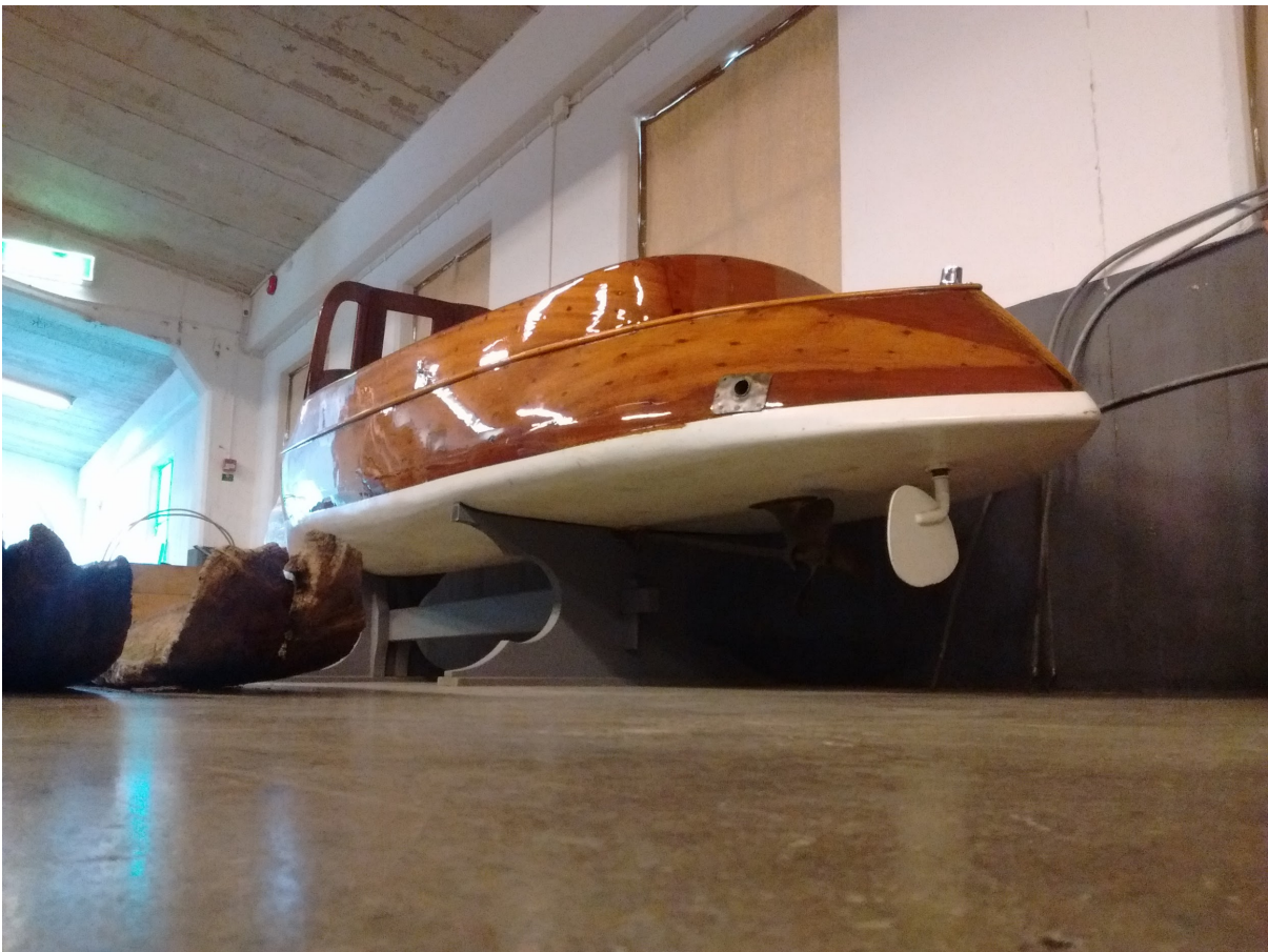
Figur 15. En bild av båten Dixie som tydligt visar problemen med ljussättningen och den reflekterande ytan. Datorn förstår inte att de vita fälten i lacken är reflektioner som kan försvinna eller flytta sig i olika kameravinklar.
