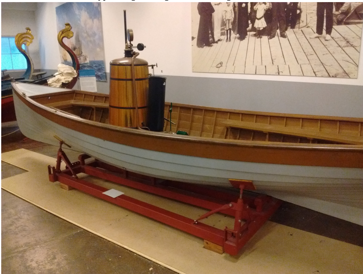
Figur 14. Colibríbåten med skivorna för lodning placerade på golvet. Skivorna tas sedan med hem till verkstaden och utgör grunden för linjeritningen.
