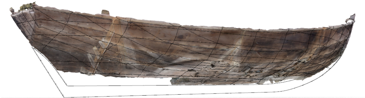
Figur 12 visar hur kölpartiet rekonstruerats i Rhino.
