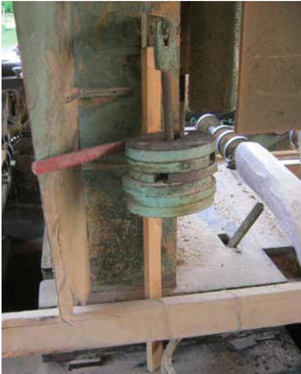
Foto 8: Pinne under väktarna för att släppa trycket.
