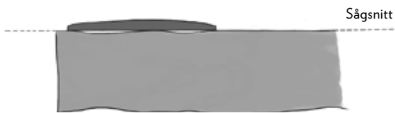
Bild 15: Kontroll av sågsnitt med linjalen.
