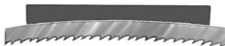
Bild 23: Ryggen av bandet hålls mot en lång linjal som är rak, för att kontrollera om baksidan är rak eller svagt böjd.
