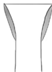
Bild 18: Genomsnitt av en tand med beläggning.
