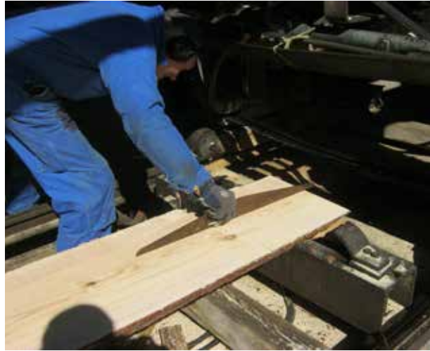
Foto 7: Kontroll av sågsnitt på CD-sågen.
