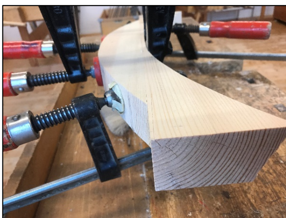
Bild 21 – Det uppstod en limskarv vid limning av spillbitar, vilket hyvlades bort innan limning.
