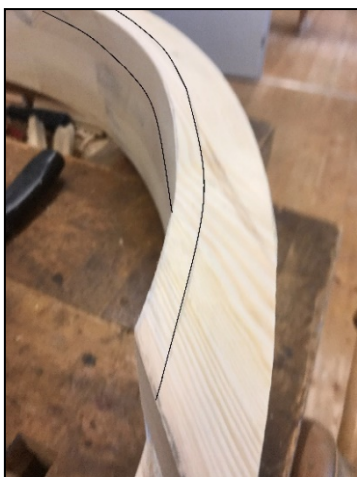
Bild 26 - Utritning av falsens mått på karmens sida och insida
