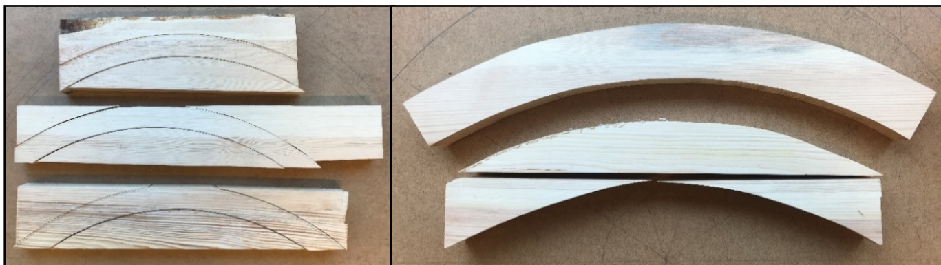
Bild 16 - Genom att limma ihop de överblivna bitarna från ursågningen av lötarna, kunde två lötar erhållas ur samma plank. Till höger ses även de korta träfibrer som blir i ändarna när den runda formen sågas ut.
