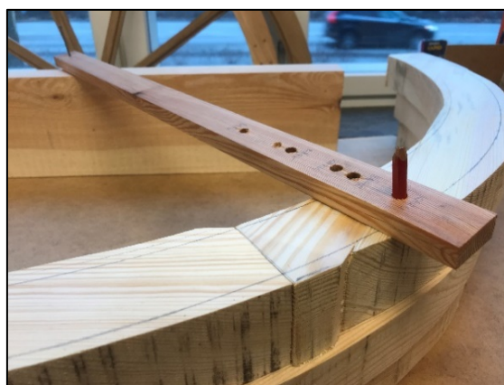
Bild 22 – Uppritning av karmens inre och yttre radie
