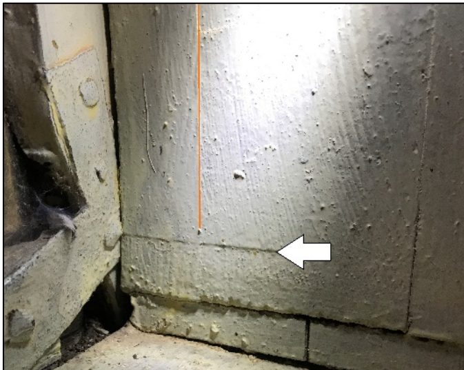
Bild 47 – Den orangea strecket visar skarven mellan lötningslagren, pilen visar ett spår av en hyvel som passerar över skarven.
