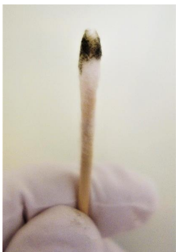
Fig. 42: Bomullspinne efter rengöring med etanol. En hel del smuts kunde avlägsnas från ytan.
