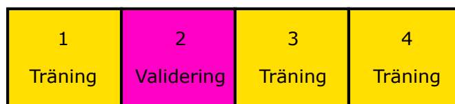
Figur 4: De olika mapparna som används för träning och validering, vid den andra iterationen. Varje ruta innefattar en mapp med observationer. Träningsmängden utgörs av alla observationer som finns i gula mappar, medan valideringsmängden enbart innehåller observationer från den andra mappen.
