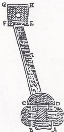
Figur 3. Tycho Brahes konstruktion av sikten 1 .
