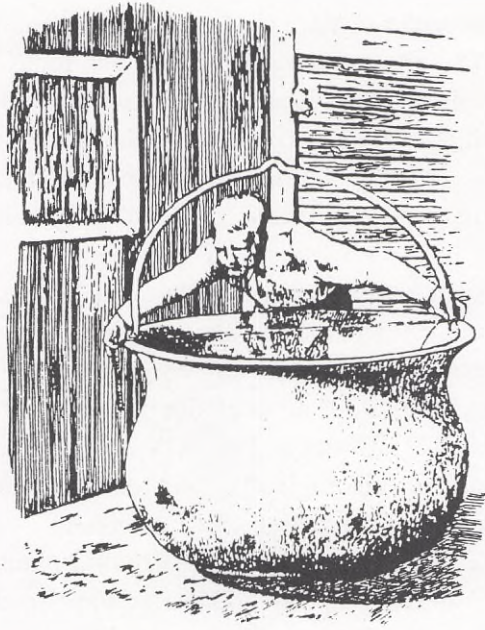
Fig. 1. Kopparkittel använd vid salpetersjudning i Finland. Teckning av S. Sundberg efter foto i Ymer 1964 [Ekström (26)].
