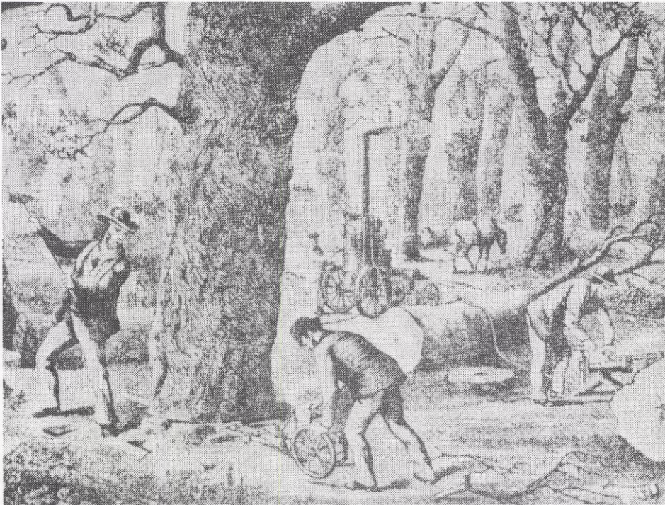
Fig 4. Omkring år 1880 gjordes försök att ersätta den mänskliga muskelkraften vid skogsavverkning med ånga. (Ilon u.å., 5)
