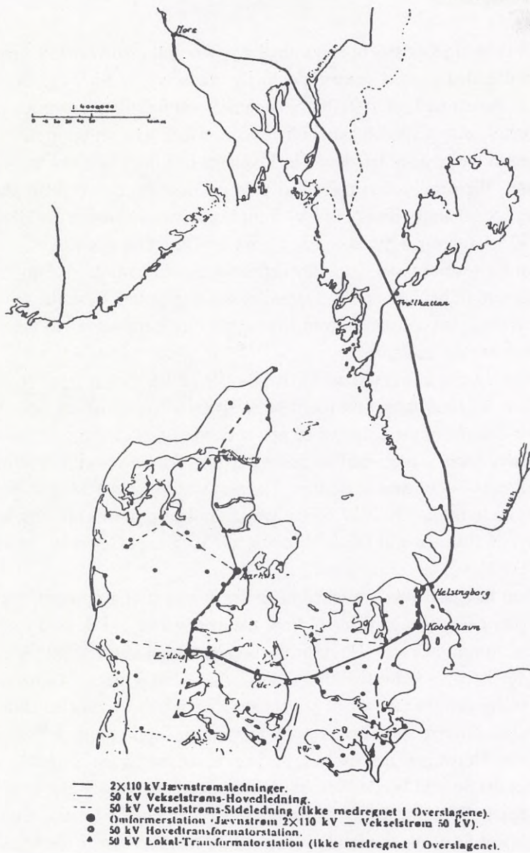
Figure 1 (left and right). Two alternatives for transmitting power from Norway to Denmark presented by a joint commission in 1922. From Redegørelse fra det af de danske, norske og svenske kraftoverføringskommissioner nedsatte elektrotekniske udvalg angaaende kraftoverføring fra Norge til Danmark , Copenhagen 1922.
