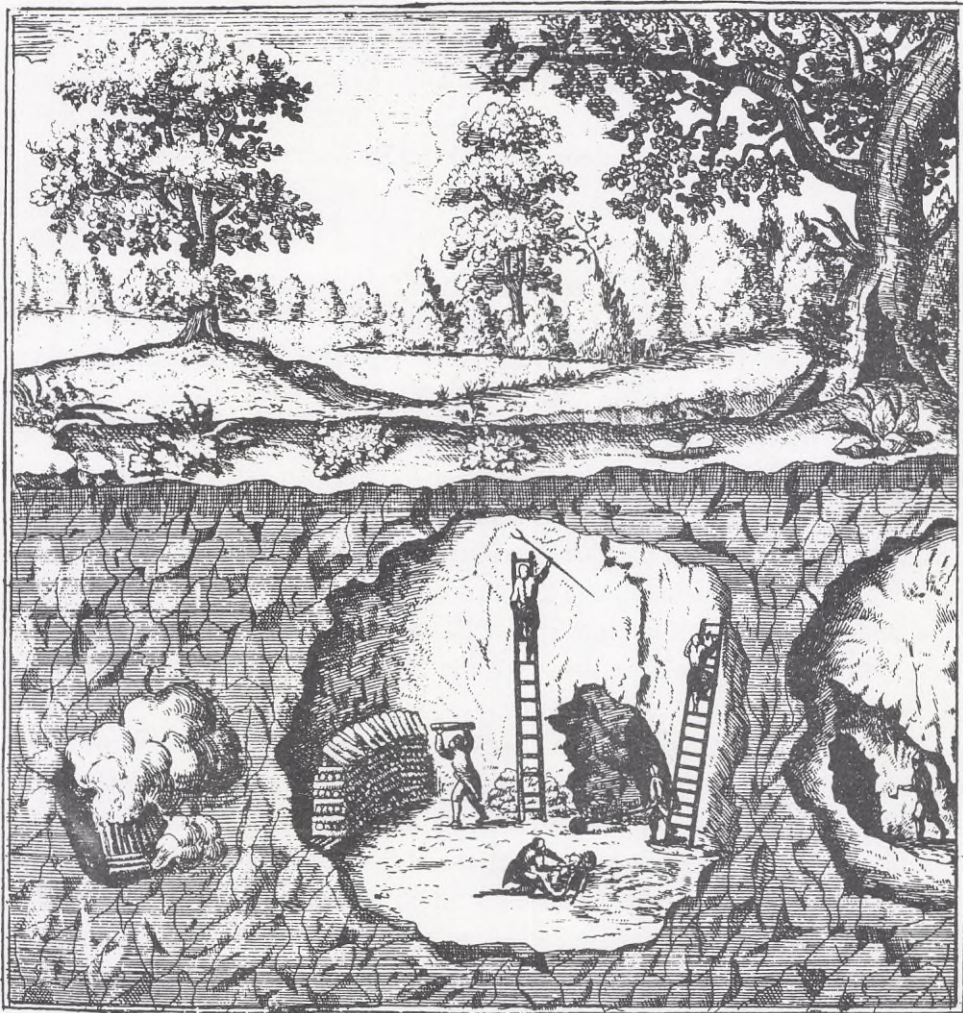
Fyrsetting slik den antakelig foregikk på de massive tinnforekomster i Sachsen (Altenberg m.fl.). Fra Balthasar Rössler: Speculum metallurgiæ politissimum (1700).
