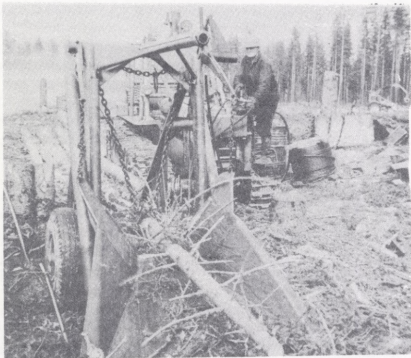
Bild 1. En tidig föregångare till kvistningsmaskinen Kvisslaren . De första försöken med mekanisk kvistning innebar att man drog eller "lunnade" hela stammen genom en kättingsnara. Källa: Skogsmuseet.
