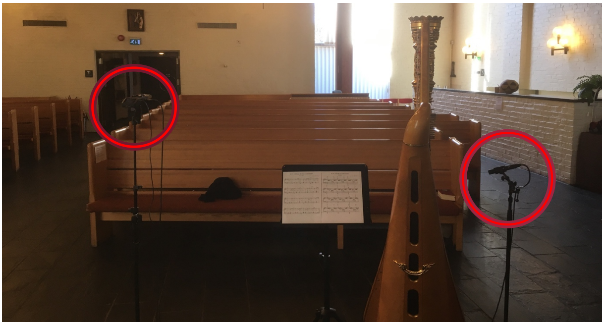
Figur 2. Harpans och mikrofonernas placering i rummet. Mikrofonerna inringade i rött.
