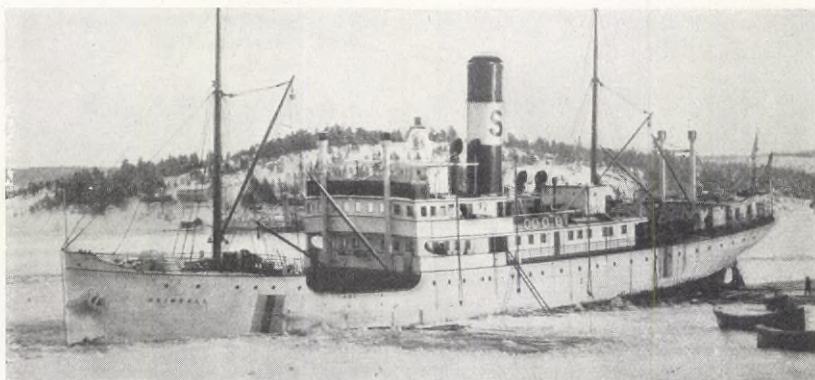
SVEABOLAGETS ÅNGARE "HEIMDALL" INFRUSEN I SUNDSVALLS HAMN och med propellerskada under utbrytning för sig och flere af bolagets ångare. I och för utbyte af propeller har fören genom belastning med is sänkts.
