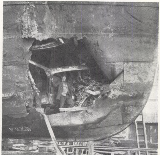
DEN VID FALSTERBOREF MINSPRÄNGDA ÅNGAREN "MARTHA". T. v.: Ångaren i Malmö hamn efter katastrofen, t. h.: Språnghålet. (Text å sid. 416).
