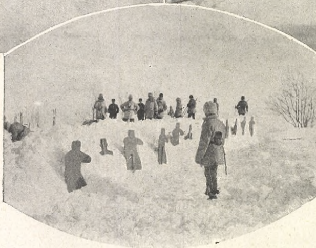
SKARPSKJUTNING MOT SNÖVÄRN för att utröna snöns motståndskraft.
