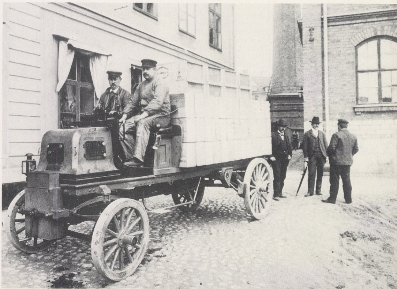
Den utrangerade "Bullerbussen" från Drottninggatan i Stockholm ombyggd till lastbil för Liljeholmens stearinljusfabrik i Stockholm. Foto från år 1900
