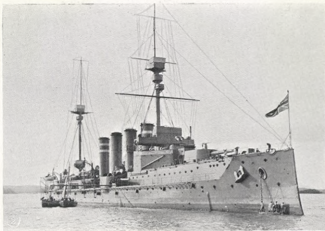
1. CHEFSFARTYGET, SLAG- SKEPPSKRYSSAREN "INDOMI- TABLE": deplacement 17,300 tons, 8 st. 30 s cm. och 16 st. 10 s cm. kanoner; 26 knop; kostar 31 s mill. kr.
