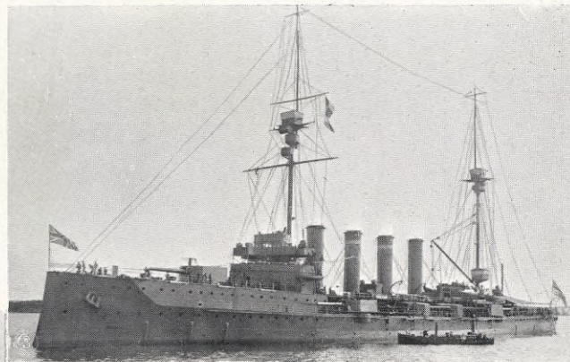
1. CHEFSFARTYGET, SLAG- SKEPPSKRYSSAREN "INDOMI- TABLE": deplacement 17,300 tons, 8 st. 30 s cm. och 16 st. 10 s cm. kanoner; 26 knop; kostar 31 s mill. kr.
