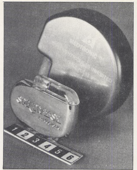
10 år och 115 g skiljer den stora pacemakern från den mindre. Med forskning och utveckling har den lilla – 35 g tunga – längre livslängd och fler funktioner.
