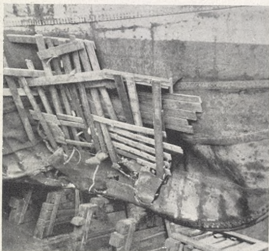
Amatörfoto. U. Mellander, Gbg. Utsida. Besigt. Skiffsverksamhet TRANSATLANTIC-ÅNGAREN "THYRA" EFTER MINSPRÄNGNINGEN. — Text å sid. 517.
