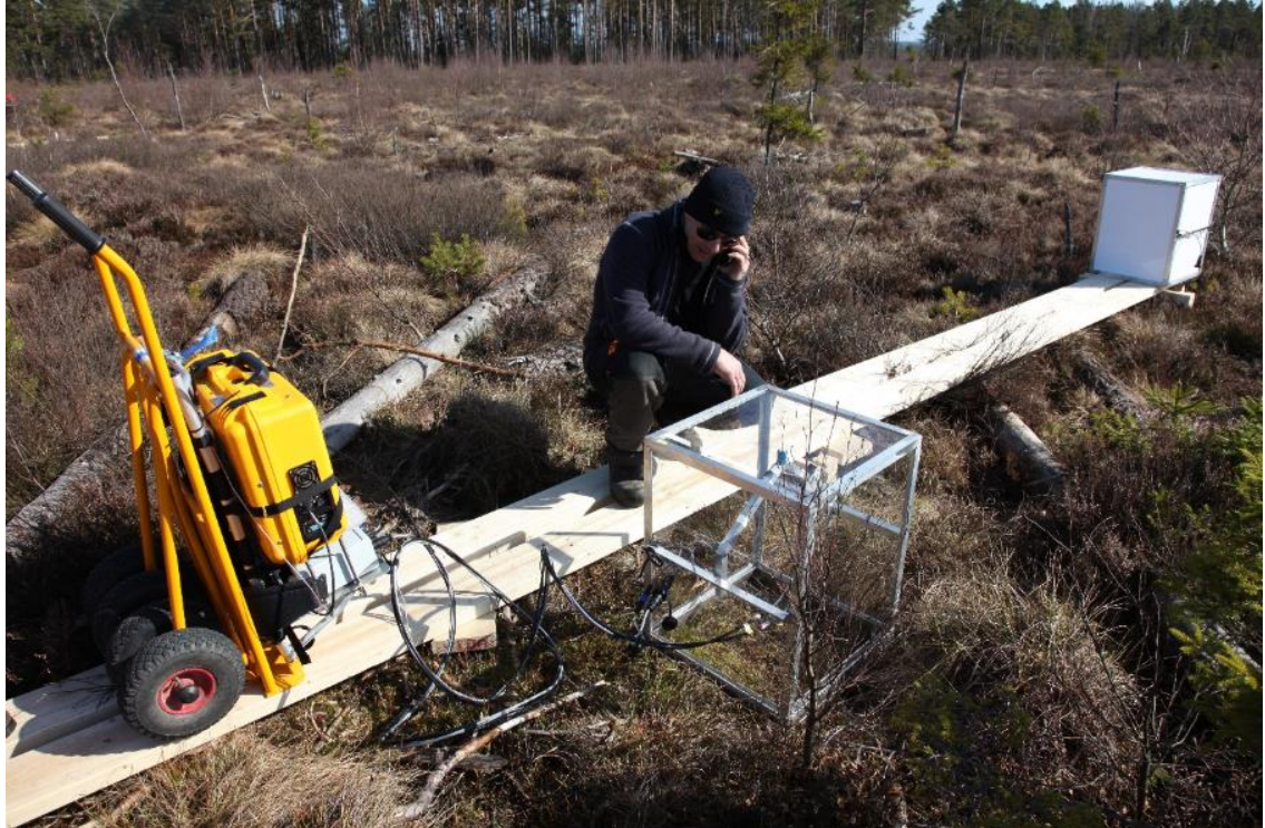
Bild 3. Fältmätning med transparent kammare, UGGAn ses till vänster i bild. Foto: Åsa Kasimir.
