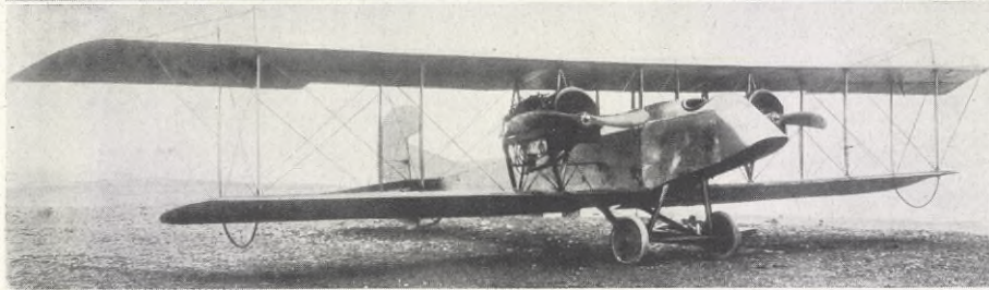
CURTISS LUFTKRYSSARE, med två 100 hkr. motorer. Plats för spanare fram till samt med kulspruta eller mindre kanon. Hastighet 150 km. pr timme.
