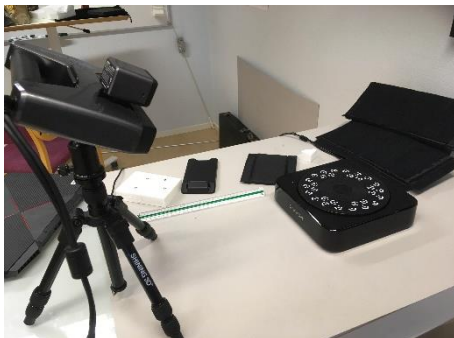
Bild 5: Uppställningen av skanning med strukturerat ljus.
