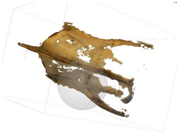
Bild 20: 3D modell byggd utifrån "dense cloud" där man kan se hål i modellen.
