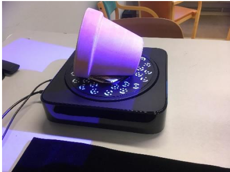
Bild 8: Terrakottakrukan med tidningspapper som stöd vid skanning.
