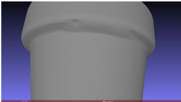
Bild 35: En del på modellen där "watertight" alternativet skapat problem i modellens form.
