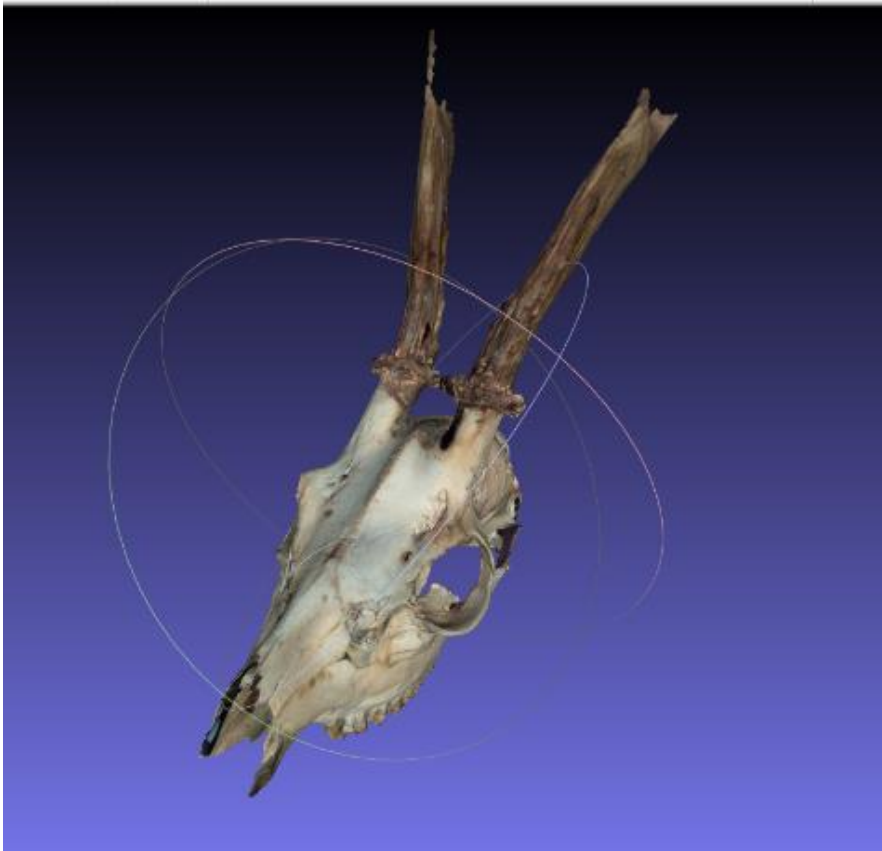
Bild 30: Den slutgiltiga modellen av rådjursskallen här med texturering. Hornen är inte helt med i modellen och det syns lite svarta fläckar längst fram, vilket kommer från den roterande plattan. Länk till 3d modell: https://skfb.ly/6SMKU
