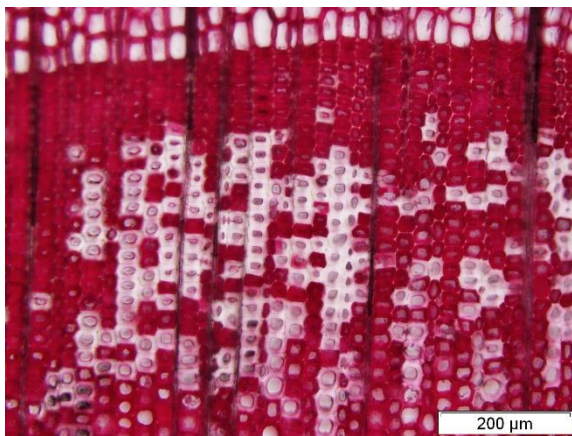
Fig.7 Visar angrepp av erosionsbakterier i ett tvärsnitt av barrträd i mikroskop. Celler som blivit nedbrutna har fyllts upp av infärgning inför undersökning i mikroskop. Foto © C. Björdal
