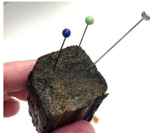
Fig.14 Visar nålar som satts i provmaterial under testet för att undersöka sönderfallande zoner. Foto © S. Hardselius
