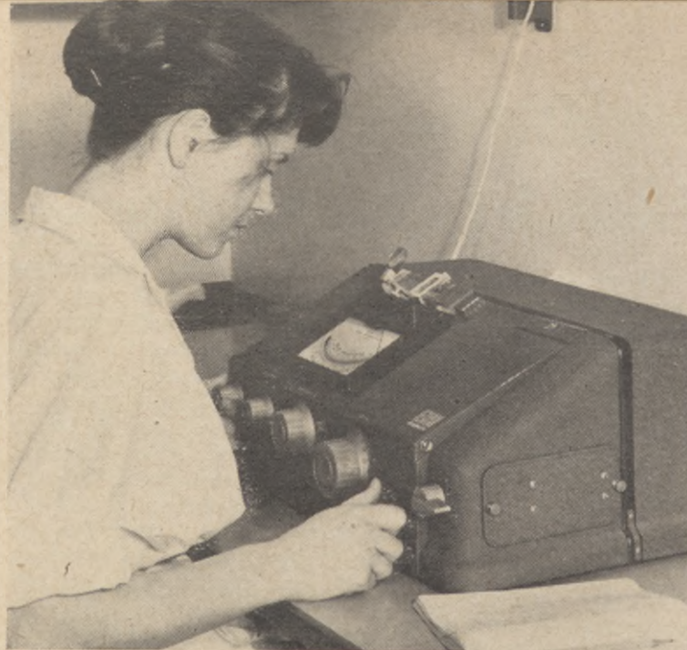
Blodets halt av det livsviktiga syret mäts i denna spectrofotometer
