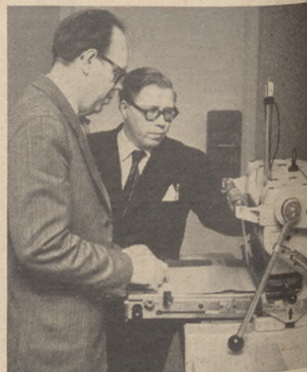
Verkmästare Nils-Erik Sundgren (t. v.) och inspektör Åke Widlund undersöker en maskin i bokbinderiet, en modern maskin, som trycker guldbokstäver på bokryggarna.
