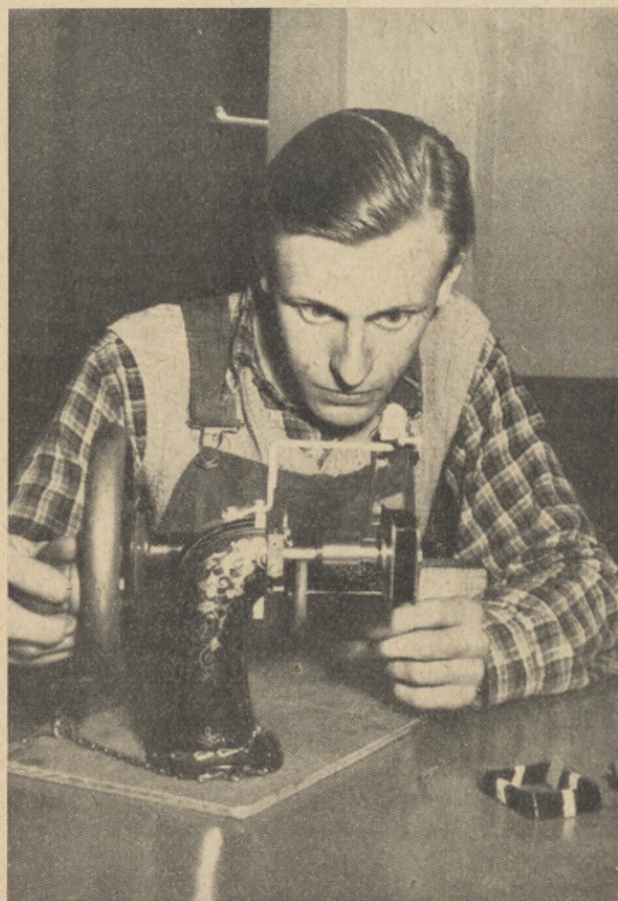
Lindning av vridspole till radarutrustning — detalj från arbetsprocessen.
