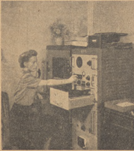
Denna bild, lånad från tidskriften "Hospital and Health Management", visar hur man från telefonväxeln sköter radioutsändningen på ett engelskt sjukhus. En automatisk skivspelare är naturligtvis inbyggd i aggregatet.
