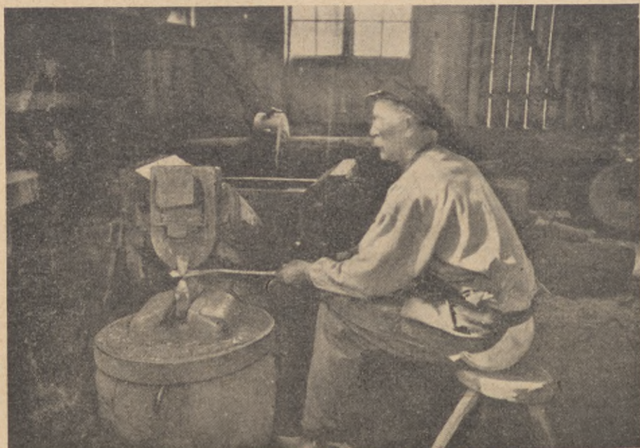
Smeden Dahlgren vid Wi Bruk, Uppland, smider ut ett lieämne under en vattenhjuldriven hammare.
