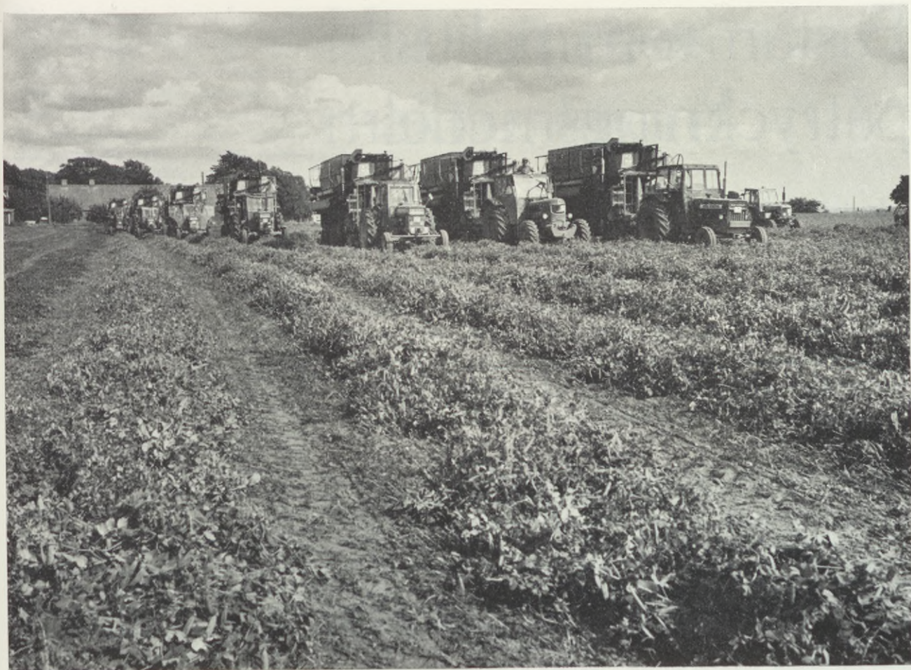
Här skördas spenat. Maskinen skär sex rader på en gång. Tyvärr har det ibland visat sig att spenat blivit giftig genom alltför kraftig konstgödsling.
