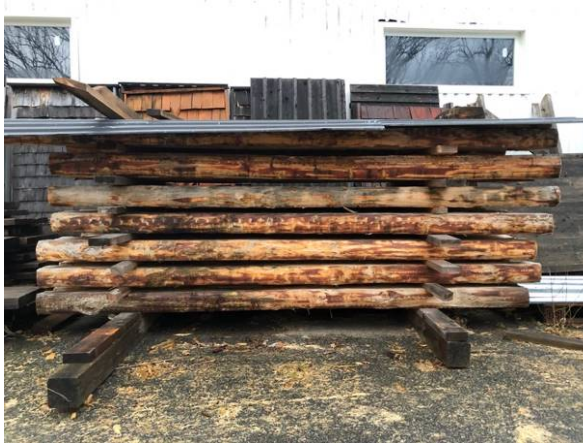
Figur 5. Timmer bilat på två sidor som legat under regnskydd sedan våren 2020.
