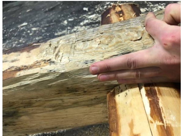
Figur 38. Ett exempel på ett litet uppstick uppmätt till "tre fingrar".
