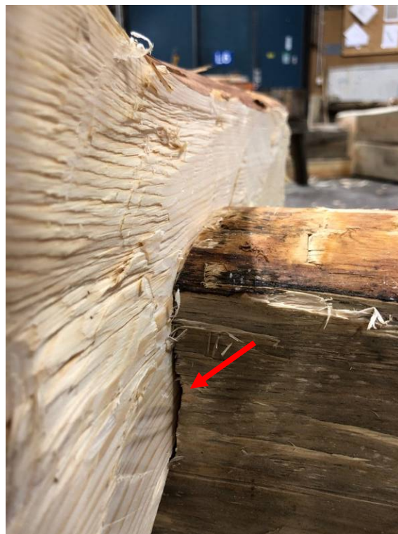
Figur 34. Ej godkänd täthet i haket. Glipan i mitten mäter upp mot ca 3mm och hänger ihop med en hellång glipa. Felet beror troligtvis på ovana att hugga med yxan och att jag har huggit förbi linjen eller syftat fel med ögonen.
