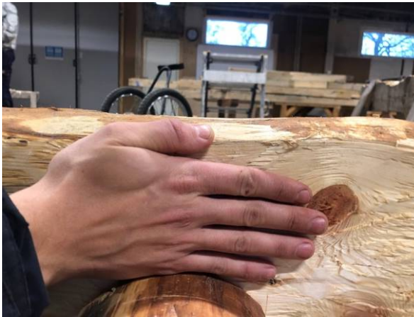
Figur 37. Exempel på uppstick uppmätt till "en tvärhand plus en tum"
