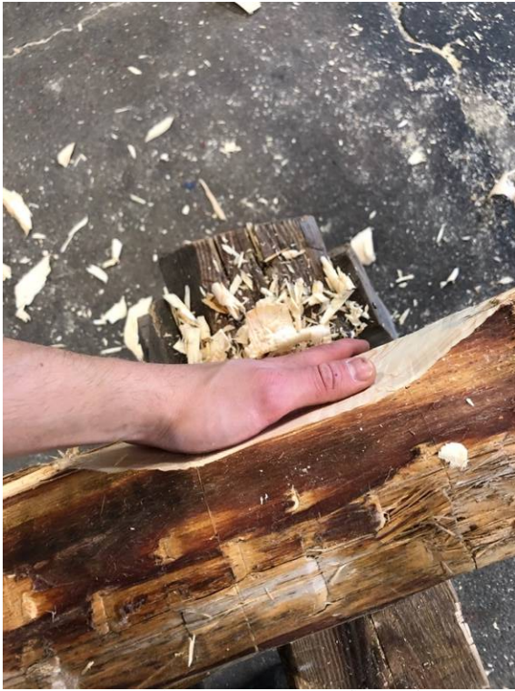
Figur 51. Till sist känner jag med handflatan efter ev. bulor som behöver jämnas till.
