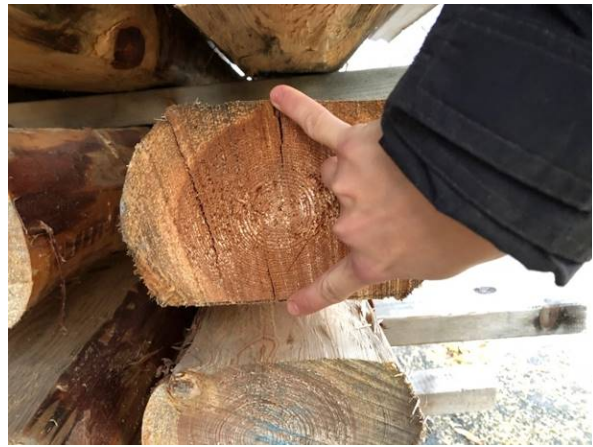
Figur 6. Genom att mäta mellan pekfinger och lillfinger kan jag uppskatta timret att vara bilat till att vara ungefär samma bredd i hela timmertraven.
