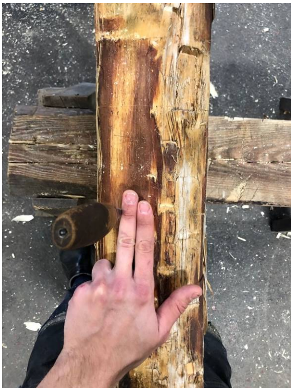
Figur 43. Bredden på botten av haket sattes ut med två fingrar på varje sida om centrummarkeringen.
