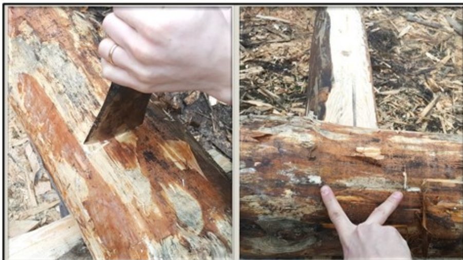
Figur 7 Moment 5. Stocken vänds. Markeringarna för underhaket sammanförs med yxa, kniv eller penna (EU 3970; EU 5221; Nordiska museet 1928). Bilden till höger visar
