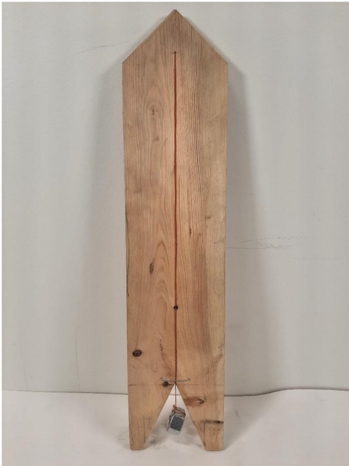
Figur 14 Lodbrädan som tillverkades med inspiration från (EU: 6671, ss. 178) bredden på brädan påverkades av timrets bredd så i detta fall blev lodbrädan 5". Höjden var mer osäker då detta aldrig anges förutom att den ska vara hög. Bilder i källmaterialet visar väldigt olika längd. Så utifrån detta så testades bara en längd som jag kände passade för vad jag trodde skulle fungera för arbetet.
