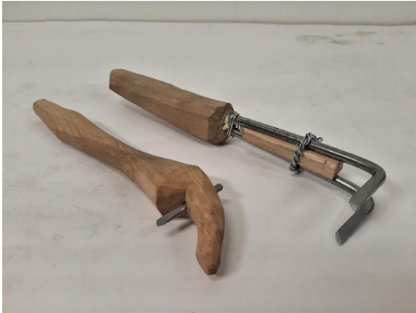
Figur 63 Timmerdragen avsatta för att dra långdrag och markera tröskeln.
