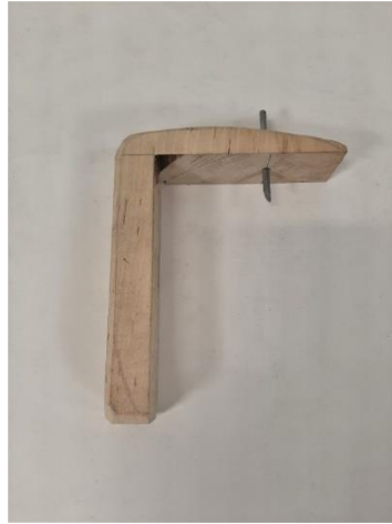
Figur 60 Var avsatt för att markera en centrumrits för dymlingar.
