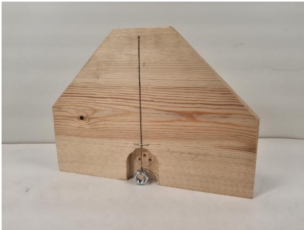
Figur 58 Avsatt för att väga in sylvarv och golvbjälklag. Väggband om det skulle kommit till det.
