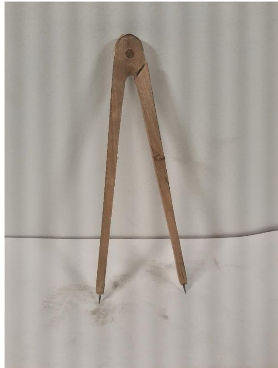
Figur 19 Passaren som tillverkades efter bild förlaga (Kulturen, inget årtal) och en genom att kolla på en stålvariant som fanns i skolans förråd. Ben i björk, tapp och slits med en björkplugg igenom. Metallspetsar fastborrade i ändarna och sedan gjordes en liten bygel av en tunn furubit som fästes i ena benet och gick i genom den andra. Låsfunktionen gjordes av en träplugg som gick igenom ena benet och låste fast mot furubygel. Bygeln blev dock väldigt skör och gick av under den sista veckan.
