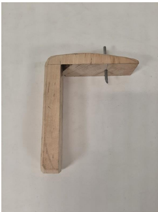
Figur 35 Timmerri som tillverkats efter en bild ur (Carlsson, 2008) och beskrivs där för att markera ut vid virkesberedning av timring. I Hantverket i gamla hus (2007) använder sig Roland Åkerman av en kallad timmermansvinkel, en vinkel gjord av plywoodskiva med ett 90 gradigt hörn. Av båda och gjorde denna. Konsekvent markera en centrumrits för en placering av dymlingar.
