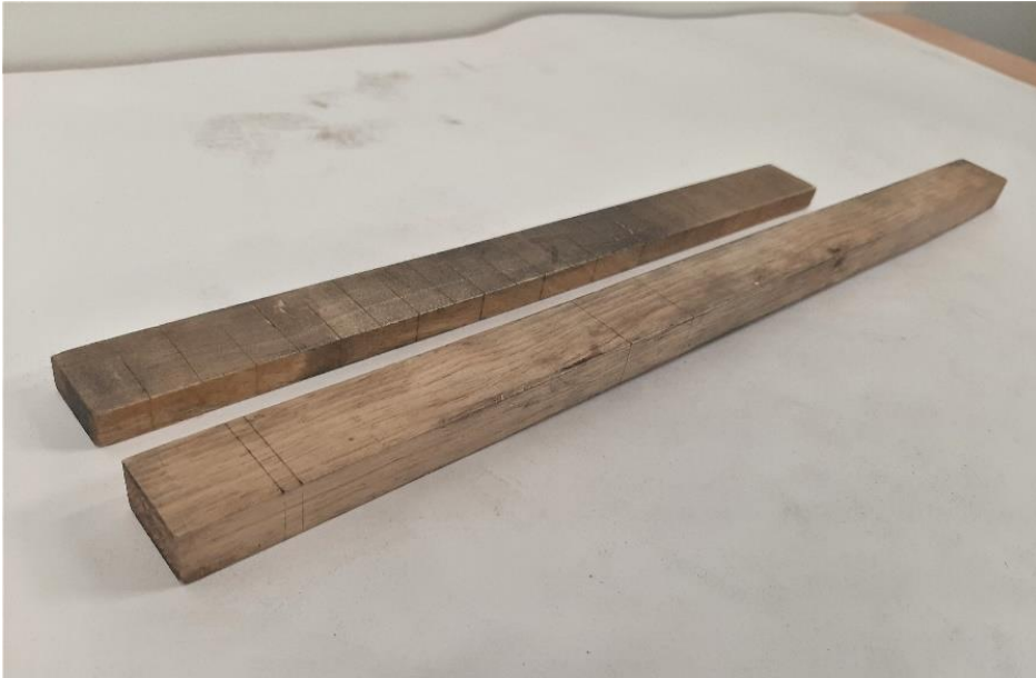
Figur 21 Två olika måttstockar, den ena i björk och den andra i fur. Den övre har en gradering i tum och halvtum enligt det system som används idag. Den nedre har bara de mått som behövdes under undersökningen med ritsar för inhakets djup i överhaket och underhaket, dymlingar, hakets bredd. Alla mått förutom hakets bredd har jag själv bestämt.
