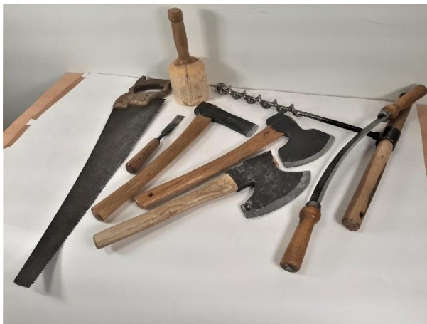
Figur 5 Från vänster: Fogsvans, träklubba, Stämjärn 1", Knutyxa, Bila rund egg, Bila rak egg, Bandkniv, Spiralnavare.
