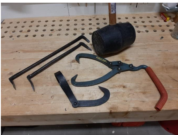
Figur 7 Från vänster: Timmerhakar, Vindhake, Timmersax, Stängselklubba
