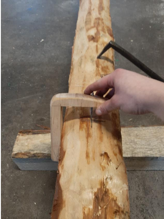
Figur 70 utformningen på timmer - riet gav sig till användning inte enbart för att marker centrum för dymling utan även för andra markeringar som skulle centreras på stockarna. Här markeras centrum knut.
