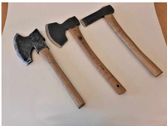
Figur 51 Andra uppsättningen. Från vänster: Bila rak egg, Bila rundad egg, Knutyxa.
