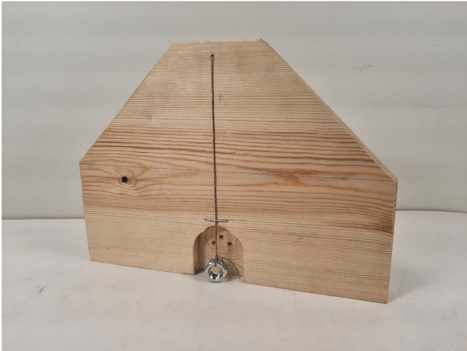
Figur 8 Vågbräda som tillverkades. Gjordes i furu ur en 2" plank. Längden på foten blev efter lodbrädans höjd ungefär då jag inte hade något att gå efter. Varför denna modell skiljer sig från skissen berodde på att den modellen inte kändes stabil, lite klen så tillverkade den efter en bild hittad hos upplandsmuseet(källa) Nu i efterhand så behövde den inte vara så bastant då detta inte påverkar funktionen något.
