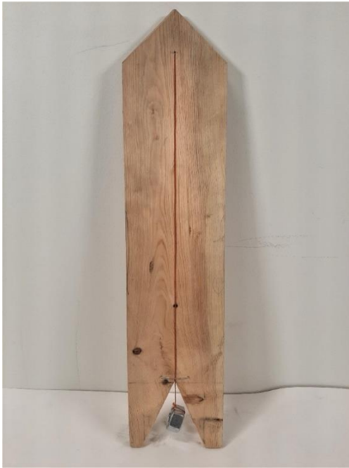
Figur 59 Var avsatt för att markera knuthakens sidor i lod. Även använda bredden till knuthaken.
