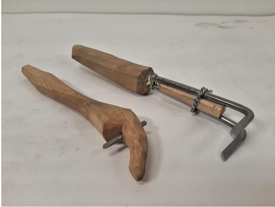
Figur 39 De två timmerdrag som tillverkades, båda med handtag i trä. Den till vänster (T1) är tillverkad i björk och är baserad utifrån en avbildning ur (Erixon, 1933) på ett estländskt drag. Den till höger (T2) är också i björk med stålstänger som skänklarna och är tillverkad efter en avbildning från (Erixon, 1933) på ett ryskt drag från Podsosna, Mincy. Skänklarna är borrade och limmade fast i trähandtaget och sedan är två ståltrådsringar fästa kring dem. Den ena är till för att fästa fast skänklarna runt kilen vid bredare drag och den andra är för att dra ihop vid smalare drag.
