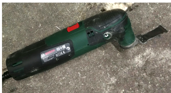
Figur 5 Multiverktyg med sågblad. I det här arbetet har jag använt mig av en annan modell än den på bilden. Jag har använt en Makita Multiverktyg DTM51, med ett 32 mm brett sågblad, avsett att användas i trä, metall och plast.
