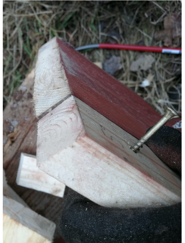
Figur 16. Metod 4. Jämförelse mellan skarvsnitt sågat på fri hand, och kloss sågat i 15° vinkel
