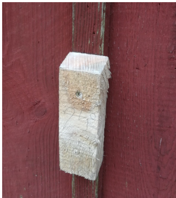
Figur 18. Egen metod. 25° kloss används för att såga av läkten
