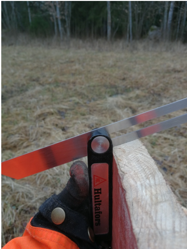
Figur 17. Metod 4, vinkeln flyttas över från den bortplockade biten med hjälp av en smyginkel
