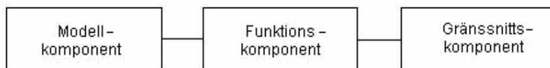
Figur 7. Enkel beskrivning av en systemarkitektur. Funktionskomponenten styr så att användaren kan uppdatera modellkomponenten. Gränssnittskomponenten är skärm, text och grafik som används för att koppla systemet till användaren och omgivningen (Mathiasen et al., 2001).
